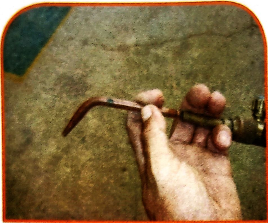
ภาพที่ 3.48 แสดงการประกอบหัวทิฟเข้ากับชุดหัวเทอร์ชเชื่อมแก๊ส
